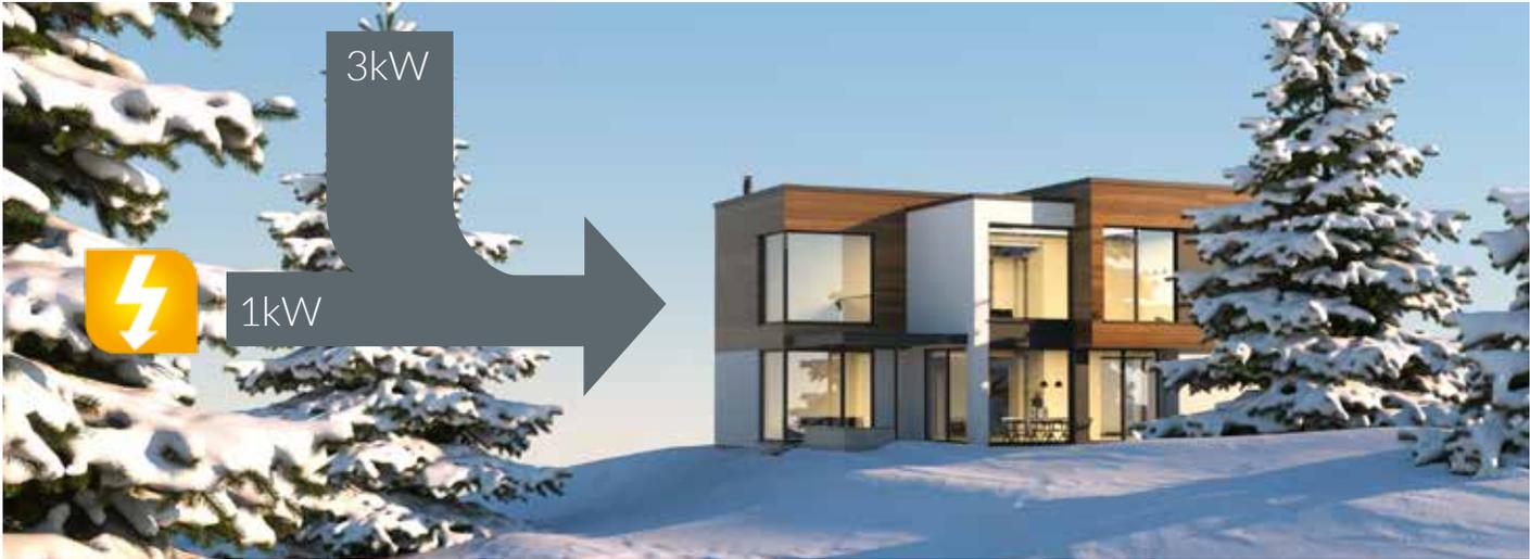
En général, il est possible de capter environ 3 kWh d'énergie pour chaque kWh d'énergie électrique dépensée, ce qui donne presque 4 kWh d'énergie thermique pour seulement 1 kWh d'énergie électrique consommée soit un rendement de presque 400 %.
